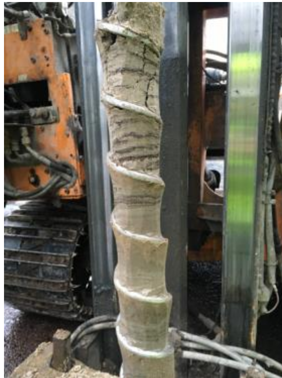
Bilden visar typisk skruvprovtagning från anläggningsområdet.
