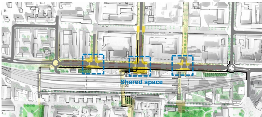
Figur 2-2 Skärmbild från Vissim-modellen som bl a visar de tre centrala korsningspunkterna där trafikanterna behöver samspela och ta hänsyn till varandra. Vidare ses även de två cirkulationsplatserna i respektive ände av Hamngatan.
